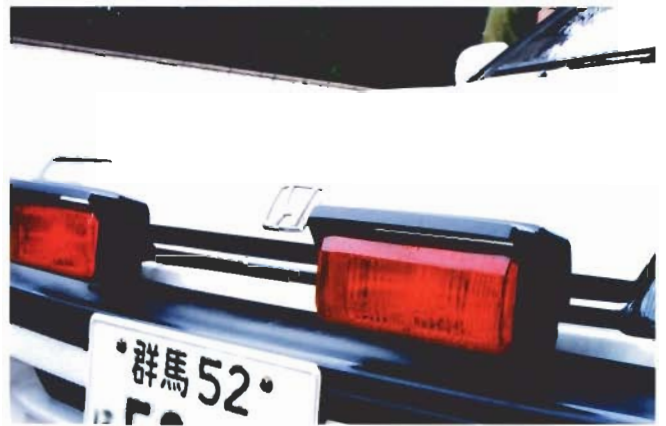
2-3 自動開閉装置付き角形前面警光燈(2燈セット)
