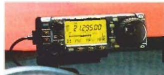
HFオールバンド+50MHz+144MHz-430MHz(SSB・CW・RTTY・AM・FM)100Wトランシーバー
